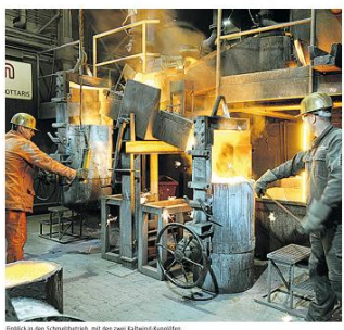
Blick in den Schmelzofen, mit dem zwei Kessel für Kupferblech.
